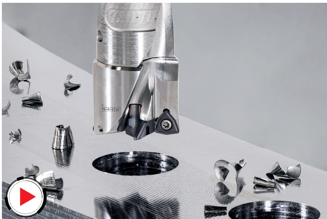
Bild 3 - MODUDRILL Borr familj med utbytbara huvuden för håltagning med stor diameter. Det nya modulära systemet består av utbytbara borrhuvuden i Ø33-40 mm och tillhörande borrkroppar i längd 3xD, 5xD och 8xD.
