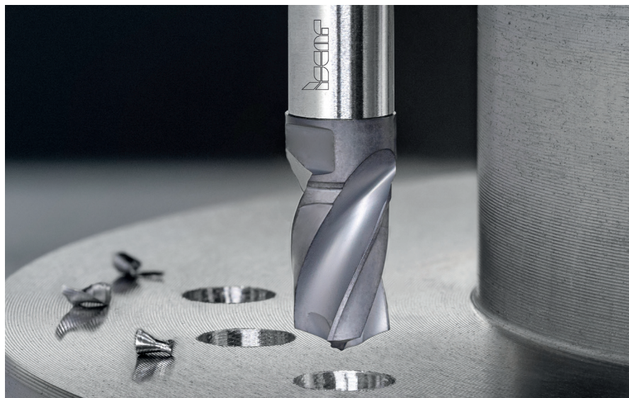
Bild 6 - MULTI-MASTER Borrhjär med 3 effektiva skäreppor- MULTI-MASTER borrhjaret kan monteras på alla MULTI-MASTER standardskaft och hållare.
