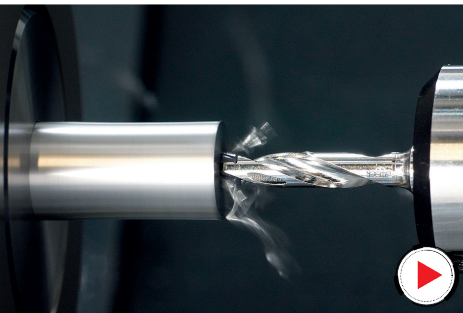
Bild 5 - PICCOSUMOCHAM är precis som det låter SUMOCHAM-borr med PICCO-koppling. PICCOSUMOCHAM har genomgående kylkanaler och är lämpliga att använda i längdsvarvar. Som alla SUMOCHAM-borrar kan borrarpeten snabbt bytas direkt i maskin.
