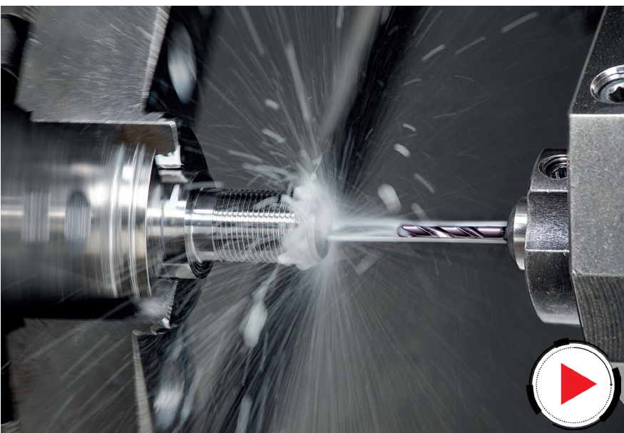
Bild 4 - PICCODRILL Solida hårdmetallborrar med PICCO-koppling för längdsvärvar och små CNC-maskiner
